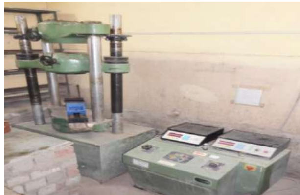
एनसीबी अहमदाबाद इकाई में स्टील परीक्षण सुविधा के लिए सार्वभौमिक परीक्षण मशीन
