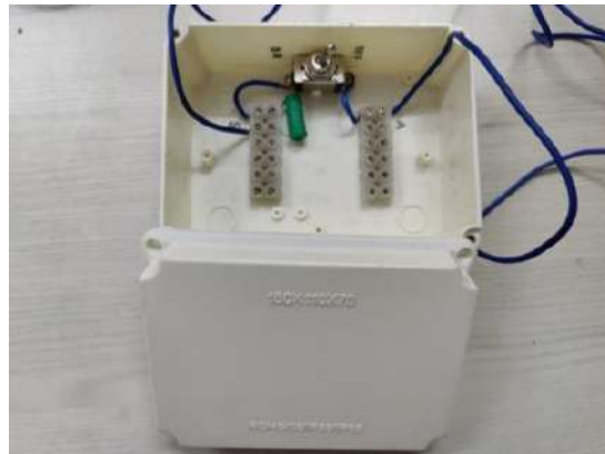
एनोड के प्रदर्शन की आवधिक निगरानी के लिए इकट्ठा किया गया जंक्शन बॉक्स
