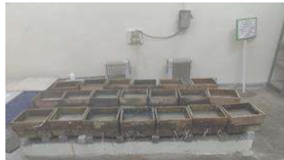
क्लोराइड प्रेरित संक्षारण के तहत प्रयोगशाला अध्ययन के माध्यम से एनोड की स्थापना के लिए चयनित कंक्रीट स्लैब नमूने
