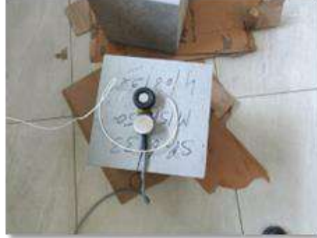
चित्र: टीपीएस 500 का उपयोग करके कंक्रीट की विशिष्ट गर्मी का मूल्यांकन
