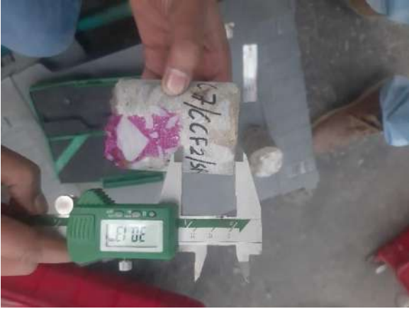
अस्पताल भवन स्थल पर ताजा निकाले गए कंक्रीट कोर पर कार्बोनेशन की गहराई मापी जा रही है
