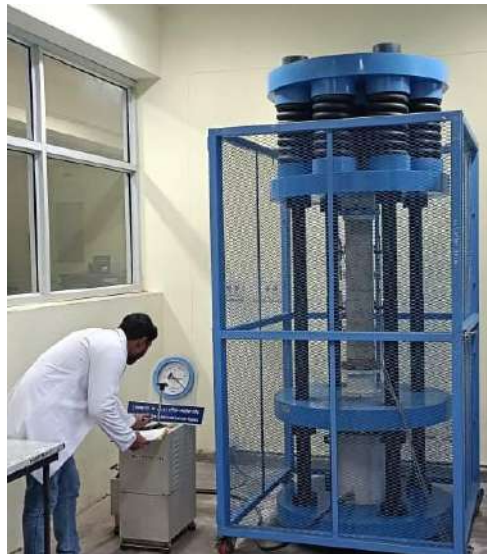
कठोर कंक्रीट नमूना सीआरईईपी अवलोकन।
