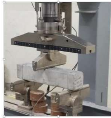
विभाजित तन्यता और लचीली ताकत के लिए परीक्षण सेट-अप
