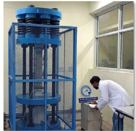
अल्ट्रा-हाई परफॉर्मेंस कंक्रीट के लिए क्रीप परीक्षण व्यवस्था
