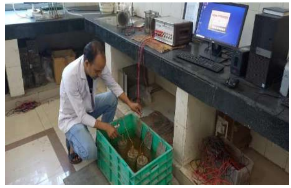
कंक्रीट का त्वरित संक्षारण परीक्षण (फ्लोरिडा विधि)
