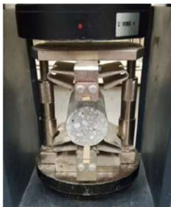
विभाजित तन्यता और लचीली ताकत के लिए परीक्षण सेट-अप
