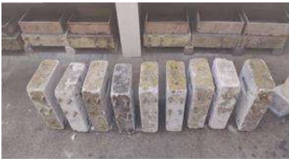
कार्बोनेशन प्रेरित संक्षारण के तहत प्रयोगशाला अध्ययन के माध्यम से एनोड की स्थापना के लिए चयनित कंक्रीट स्लैब नमूने
