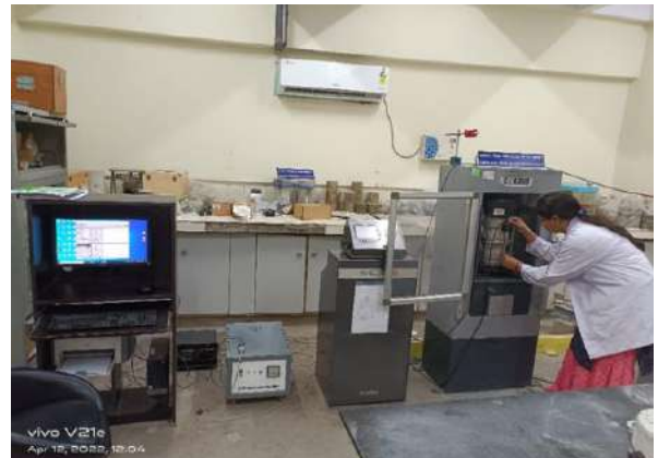
कंक्रीट की फ्लेक्सुरल कठोरता के निर्धारण के लिए तनाव नियंत्रित फ्लेक्सुरल परीक्षण मशीन
