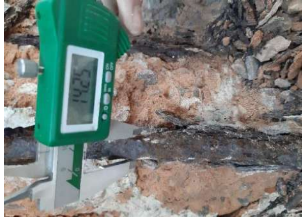
दिल्ली में एक भवन स्थल पर आरसीसी सदस्य के मौजूदा सरिया व्यास का मापन
